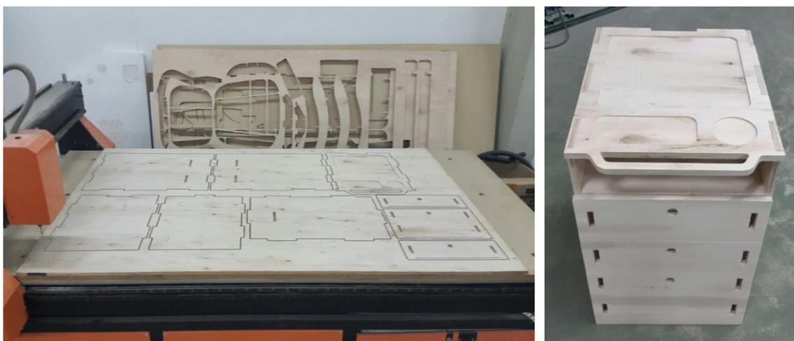
Figura 11. Fabricación y ensamblado de piezas de Cajonera móvil. Fotografías propias.
